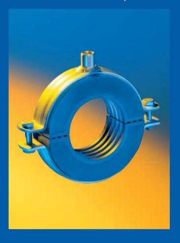
Kälterohrschelle mit 2-Komponenten PUR-Dämmeinlage zur Aufnahme von Lasten in axialer Richtung. Als Tragschelle für Steigleitungen oder als Festpunktschelle geeignet. Flexibe Anschlussmöglichkeiten über durchgesteckte und verschweißte Sicherheitsmutter 3G.
