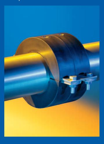
Kälterohrschelle zur Aufnahme von Lasten in axialer Richtung. Besonders geeignet als Tragschelle für Steigleitungen oder als Festpunktschelle. Die Übertragung der axialen Kräfte erfolgt über einen auf dem Rohr verschweißten Druckring. Die auftretenden Festpunktkräfte werden über den Schellenkörper auf die Befestigungspunkte übertragen.
